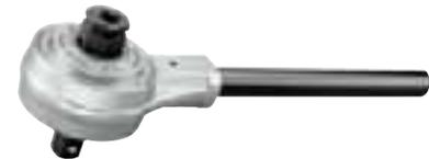
**HAHN+KOLB DREMOTEC** **Instrumento verificador del par de apriete DremoTest E**
